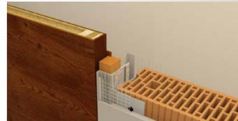
Schnittbilder des Systemrahmens zeigen: Die Alu-Zarge verschwindet unauffällig im Mauerwerk. So ergibt sich eine freie Sicht auf das Türblatt und das gesamtheitlich anmutende rahmenlose Türsystem.
