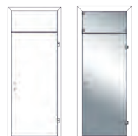
Ausführung geschoßhoch/ mit Zargenquerteil ohne Kämpfer
